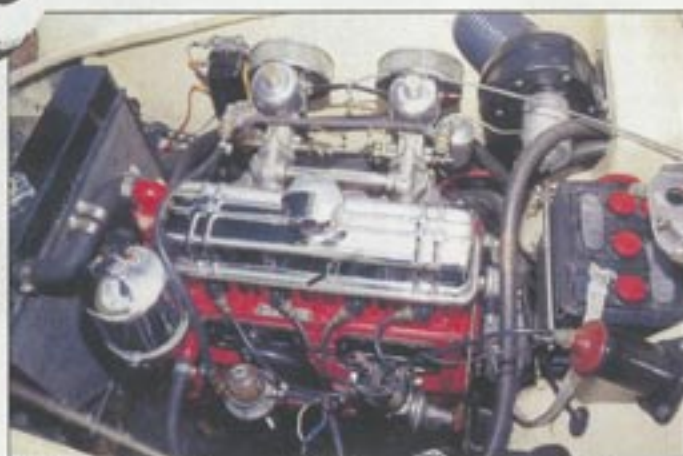
Der als B14A bezeichnete und von zwei SU-Vergasern beatmete Sportmotor schöpfte aus 1414 ccm beachtliche 70 SAE-PS.
