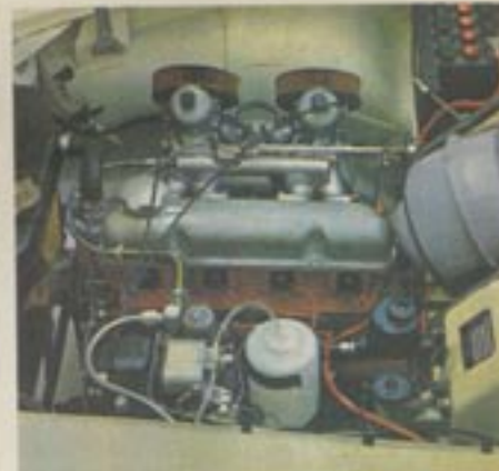
Nicht kleinrakig: B 18 B-Motor mit zwei SU HS 6 Vergasern.
