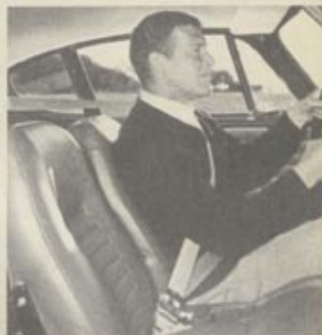
Sicherheits-Pionier: Als erster Hersteller baute Volvo ab 1958 serienmäßig Dreipunkt-Sicherheitsgurte in allen Modellen ein.
